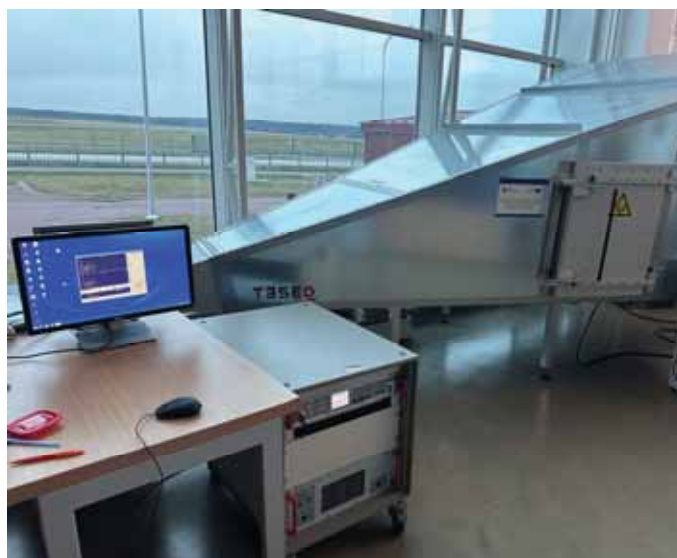
Rys. 2. Stanowisko pomiarowe do badań odporności na zaburzenia elektromagnetyczne
