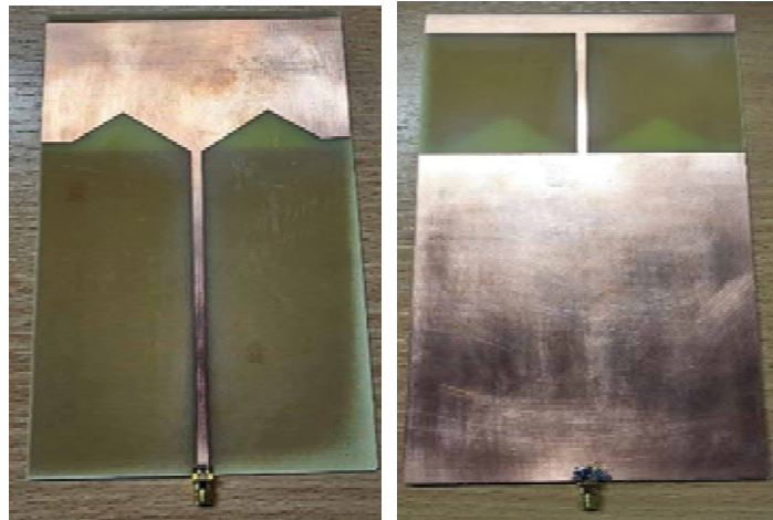
Rys. 2. Wygląd wykonanej mikropaskowej anteny DVB-T2 – widok z przodu i widok z tyłu
