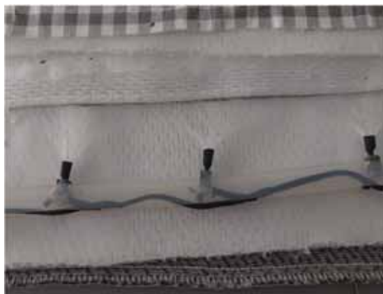
Rys. 1. Mata wykonana z n-warstw dzianiny dystansowej 3D z wdzianymi w jej strukturę światłowodami
