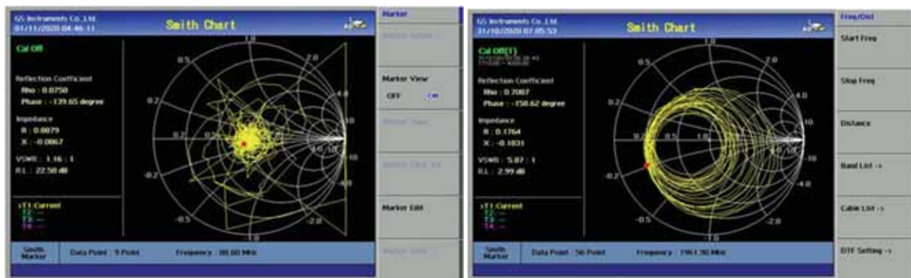
Rys. 1. a,b. Charakterystyki anten stosowanych do pomiarów emisji
