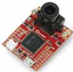
Rys. 2. Kamera inspekcji wizyjnej DFRobot OpenMV Cam H7
